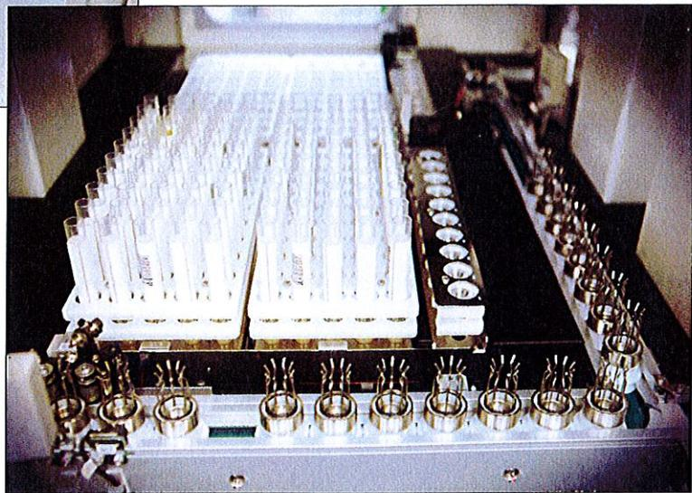
*Grazie all'area combinata di carico e scarico da 200 posizioni, alle aree per i campioni STAT e per gli errori da 10 posizioni, PowerLink fornisce un'elevata capacità e flessibilità nella gestione dei tubi prelievo, adattandosi a tutte le richieste per i Laboratori a media ed alta produttività*
