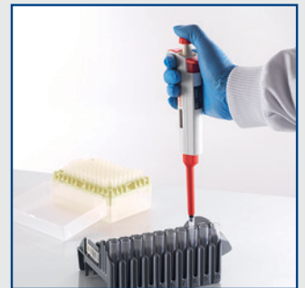
VITEK® 2 COMPACT: utilizzare la sospensione ID per ottenere la sospensione AST
