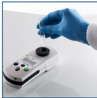
Preparazione della sospensione batterica con DENSICHEK® PLUS che assicura il corretto valore standard McFarland
